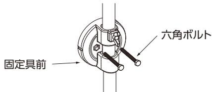
②天井物干金物を固定具前と固定具後で挟み込み、六角ボルトにスプリングワッシャーを通し、蝶ナットでしっかり締める。
