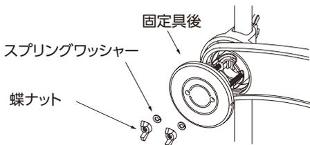
③リング(竿位置)の高さを決め、蝶ねじを締め付ける。
