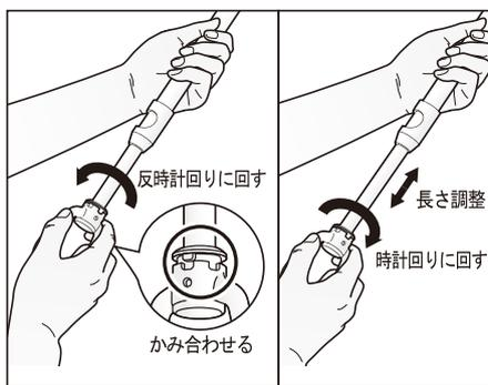
●吊材の長さ調整時は、赤ラインを超えないように調整してください。
